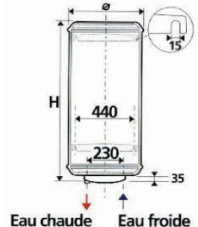
11. On propose d'utiliser une chauffe eau de forme cylindrique de 150 litres et de 440 mm de diamètre, quelle hauteur intérieure doit-il faire pour contenir le volume nécessaire ?
